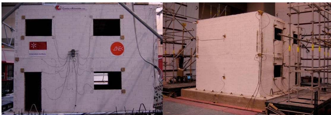
Fig. 2 – Ensaios sísmicos de edifícios em alvenaria de blocos armada (colaboração com a Universidade do Minho)
